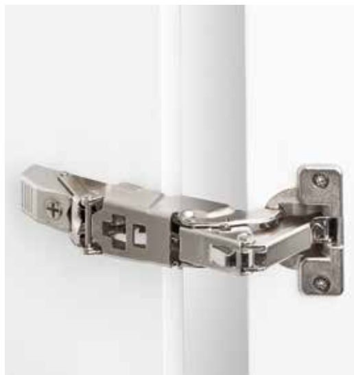
Cerniere ammortizzate regolabili nelle 3 direzioni con apertura a 155°. Disponibili con sovrapprezzo ove è possibile l'installazione.
