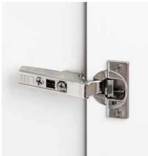
Cerniere ammortizzate ad aggancio automatico, regolabili nelle 3 direzioni, con apertura a 110°.
